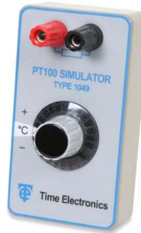
Характеристики устройства отвечают температурной кривой ITS 90. Обладая высокой точностью по всему рабочему диапазону, модель 1049 превосходит требования к функциональным характеристикам классов «А» и «В». Особенно хорошо имитатор 1049 работает в диапазоне -60°C ÷ + 60°C, где он заведомо превосходит требования класса «А» (т.е. погрешность лучше  $\pm 0,15^\circ\text{C}$ ).
